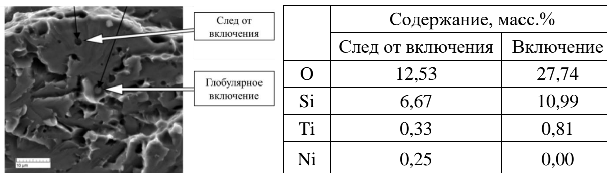
Рис.7. Включение и след от включения на фрактограмме и результаты химического анализа образца с содержанием TiN.
