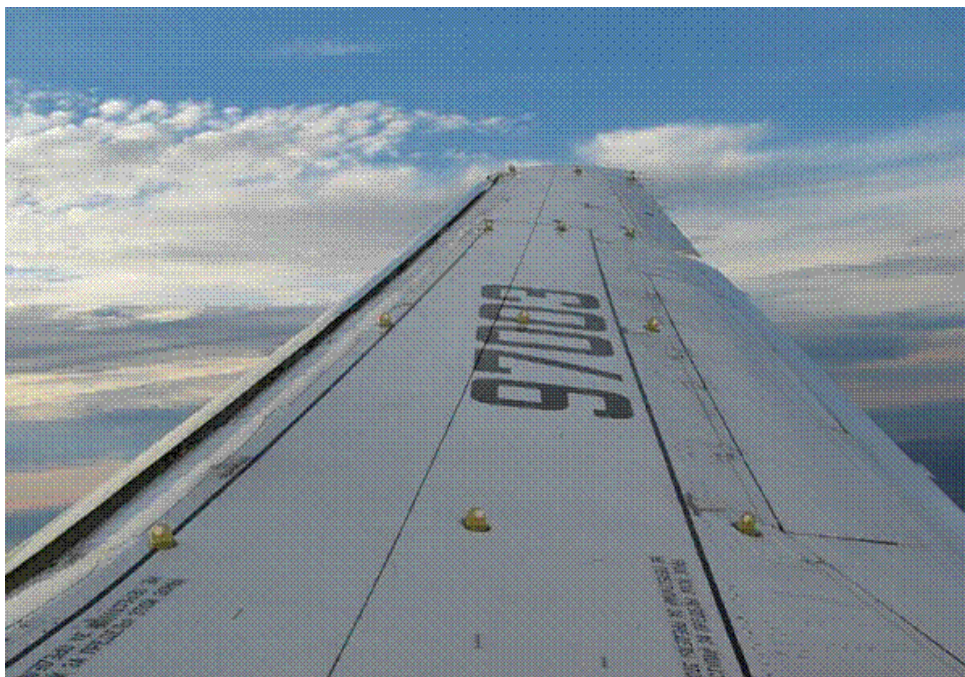
Рисунок 12. Замеры деформаций крыла в полёте фотограмметрическим методом.
