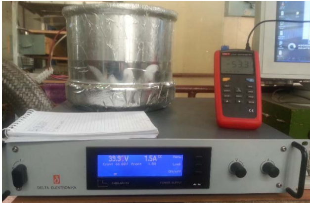
Рисунок 7. Экспериментальный стенд для определения коэффициента теплоотдачи от гранулированного диоксида углерода
