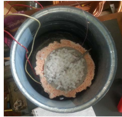
Рисунок 7. Экспериментальный стенд для определения коэффициента теплоотдачи от гранулированного диоксида углерода
