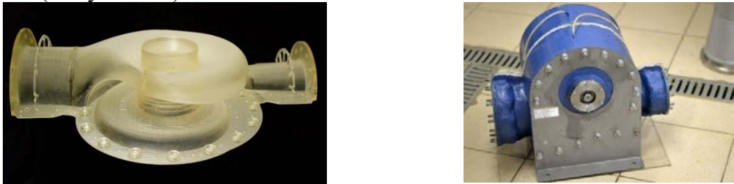
Рисунок 17. Изготовление макета для испытаний проточной части
