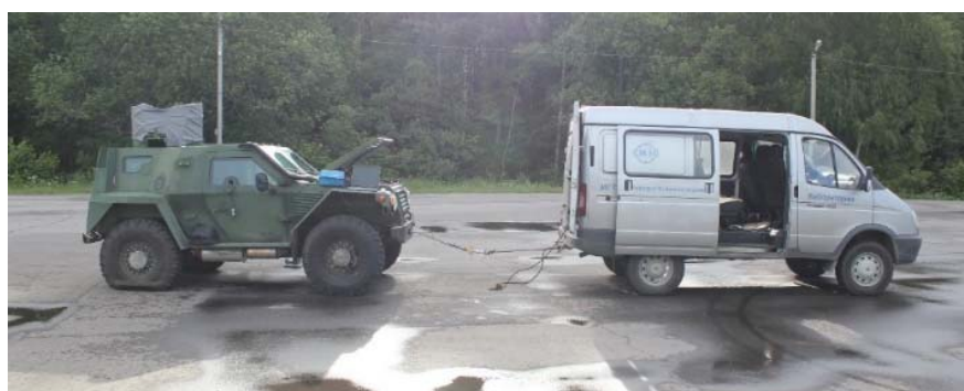
Рис. 10. Определение сопротивления качению колёса
