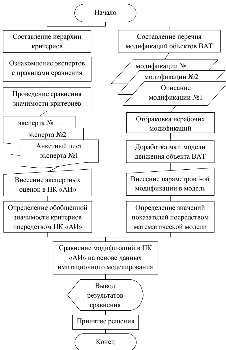
Рис. 12. Алгоритм методики повышения приспособленности к эвакуации ВКМ на этапе проектирования
