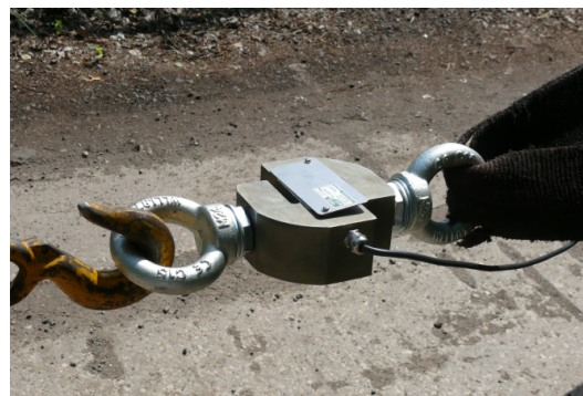
Рис. 10. Установка тензодатчика в сцепке
