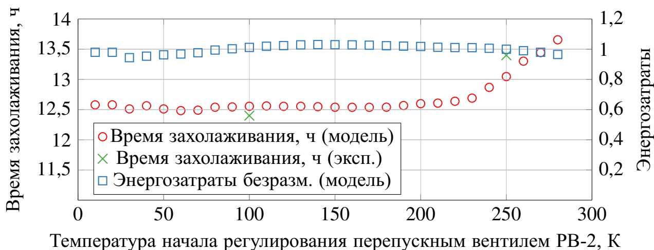
Рисунок 10. Зависимость общего времени захлаживания от уставки начала регулирования перепускного вентиля РВ-2
