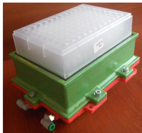
Рисунок 4. Экспериментальный стенд: а – схема экспериментального стенда установки вакуумной сепарации, б – фотография блока вакуумной сепарации.
