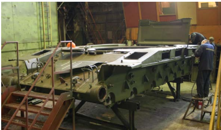
Рис. 30. Однодуговая механизированная сварка в труднодоступных местах
