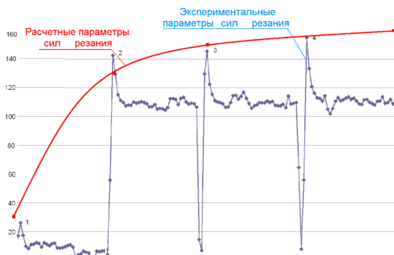
Рис.3. График изменения силы резания при обработке «дна»
