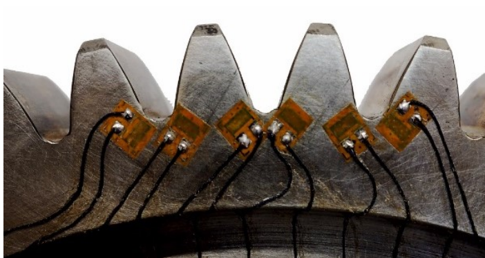
Рисунок 9. Расположение тензодатчиков на торце экспериментального зубчатого колеса
