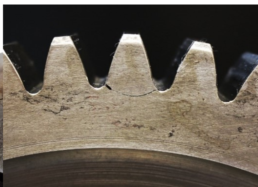
Рисунок 10. Вид усталостной трещины и подреза во впадине экспериментального зубчатого колеса
