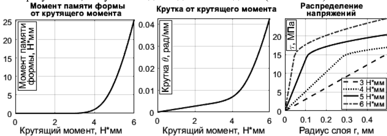
Рис. 4. Зависимости для момента памяти формы, крутки и распределение напряжений по сечению при различных значениях M_{кр}
