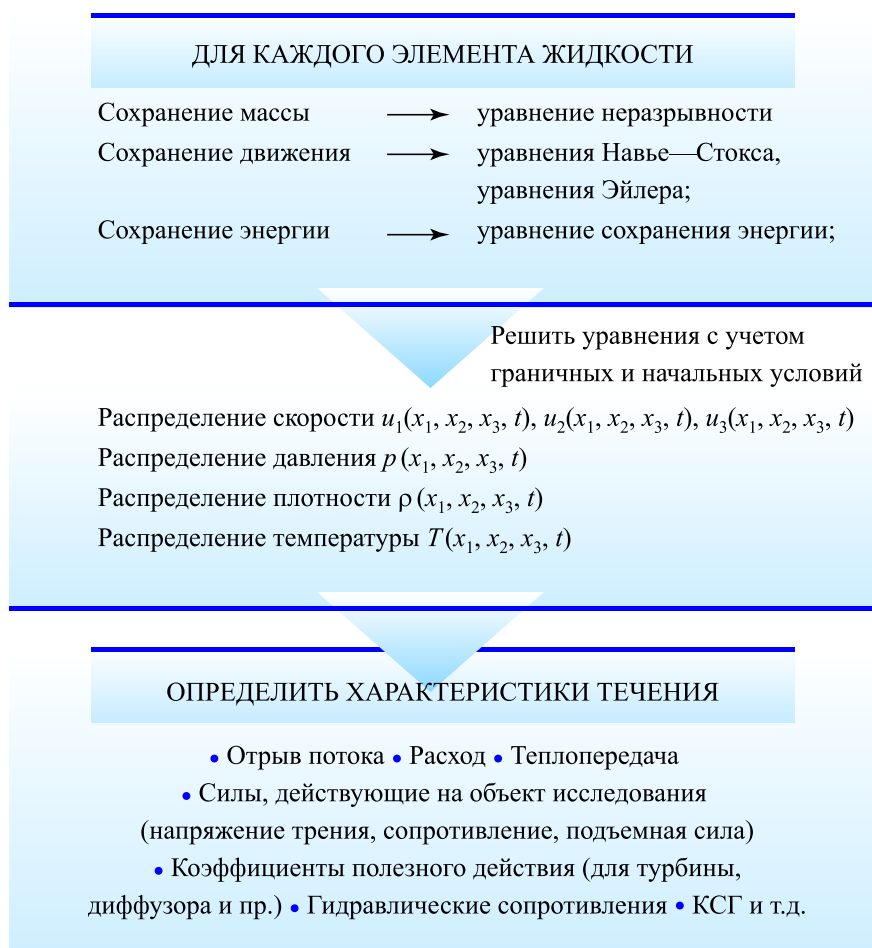
Рис. 1. Схема применения методов вычислительной гидрогазодинамики
