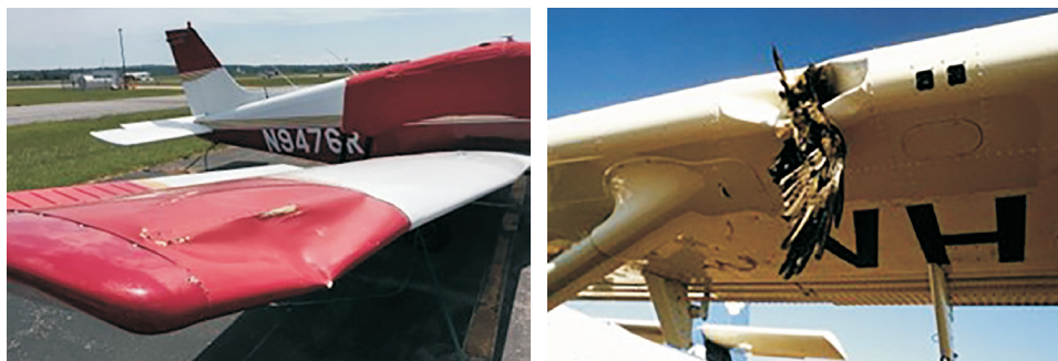
Рис. 2. Результаты повреждений конструкций самолетов при ударах с птицами
