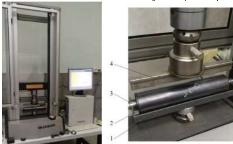
Рис. 4 – Общий вид испытательной машины Quasar 50 и роликовой опоры в сборе 1 – основание, 2 – НР, 3 – ось/полуось, 4 – подвижная балка
