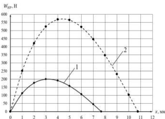
Рис. 6 – Сила сопротивления W_{HP} передвижению паллеты при её взаимодействии с ненагруженным НР диаметром D_{HP} = 60 мм и жесткостью c_p = 2000 Н/мм для \Delta h = 1 мм (1) и 2 мм (2)
