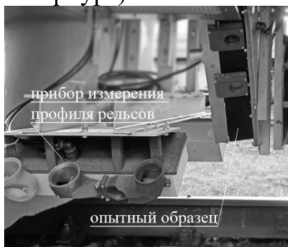
Рисунок 8 – Фотография испытательного образца ОЭС для оперативного контроля дефектов поверхности катания железнодорожного пути
