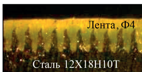
Рис. 16. Макроструктура с запрессованной фторопластовой лентой
