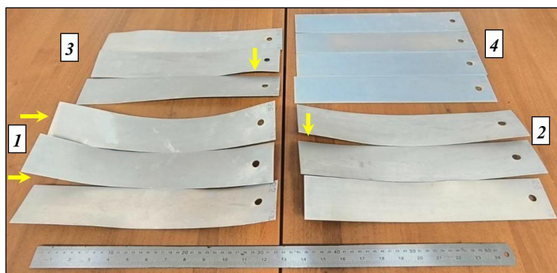
Рис. 11. Внешний вид листовых заготовок толщиной 1,2 мм из сплава В-1341 после закалки в разные среды (стрелками указаны участки с наибольшим короблением):
