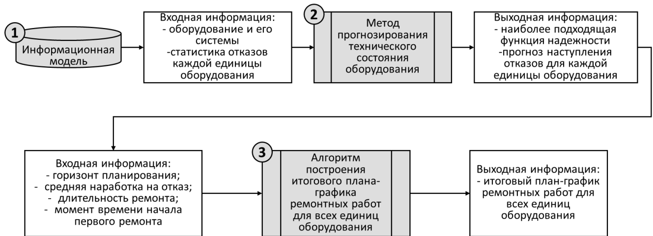
Рисунок 6 – Организационно-технический метод организации работ по техническому обслуживанию и ремонту оборудования
