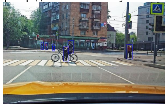
Рисунок 5. Оценка положение объектов в пространстве на основе камеры в режиме реального времени
