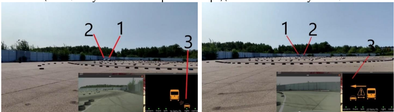
Рисунок 7. Испытания на полигоне для разных систем помощи водителю и различных сценариев. Где: 1 — ТС с ИСПВ, 2 — участник дорожного движения, 3 — предупреждения в соответствии с текущей ситуацией
