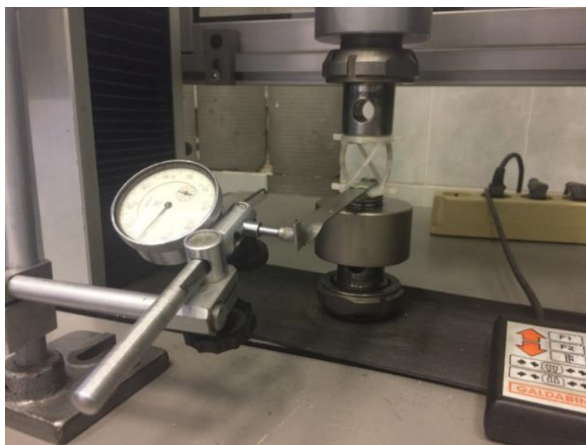
Рис. 15. Экспериментальная установка на базе испытательной машины GALDABINI QUASAR 50
