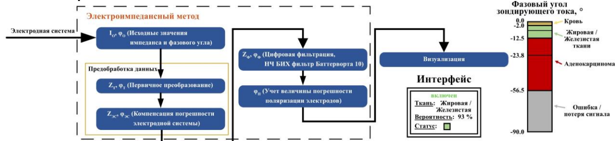
Рисунок 11. Алгоритм обработки измеренных значений амплитуды и фазового угла зондирующего тока
