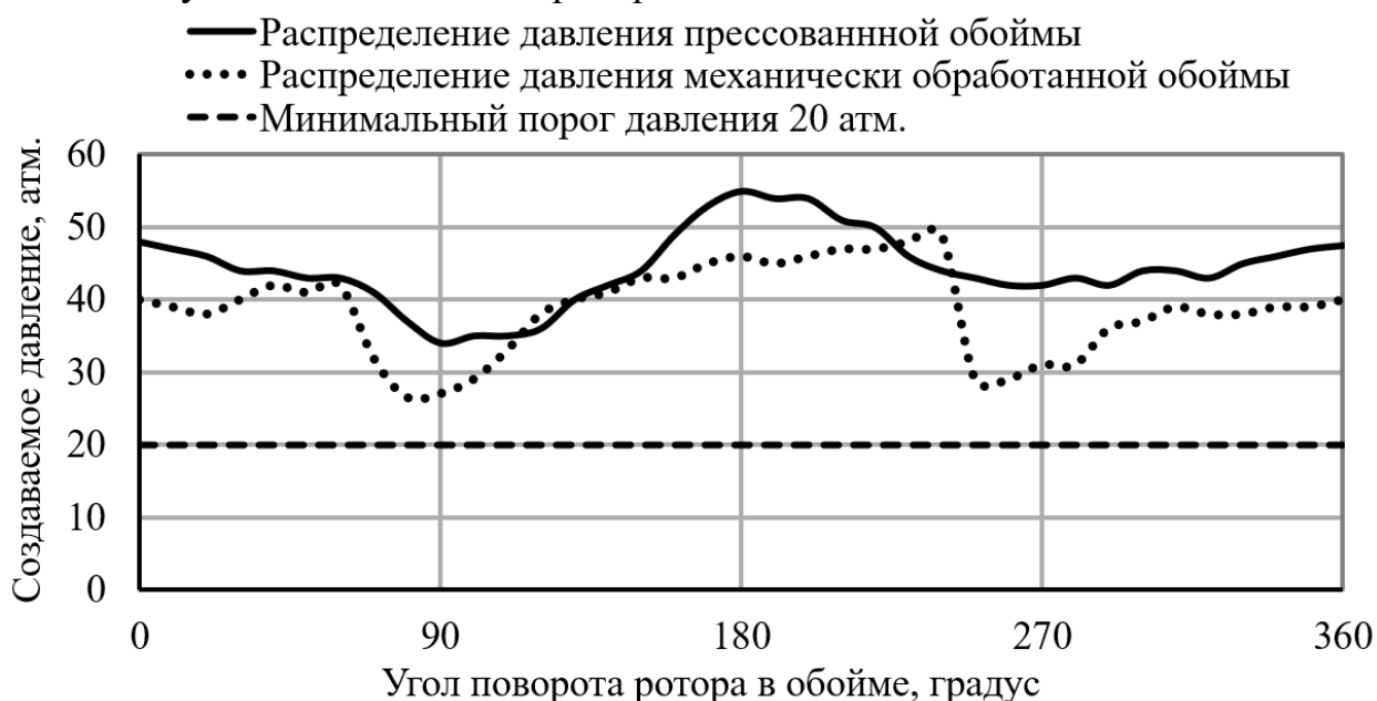
Рисунок 12. Диаграмма распределения давления одновинтового насоса для прессованной обоймы и лезвийно обработанной обоймы
