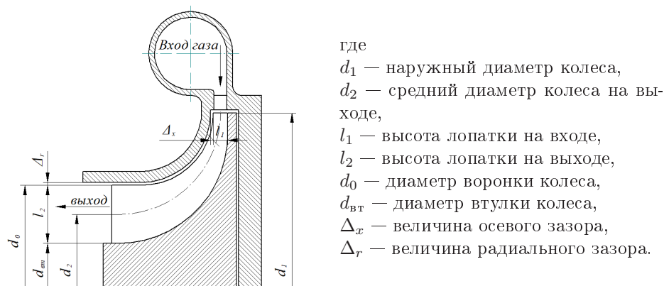
Рисунок 1 — Схема проточной части детандера турбохолодильника.
