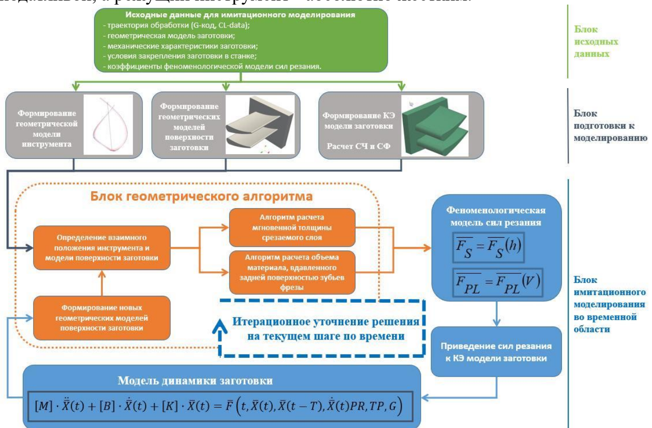
Рис. 1. Структура имитационной модели динамики многокоординатного фрезерования податливых деталей из труднообрабатываемых сплавов
