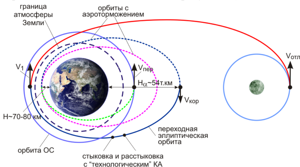
Рисунок 18. «Гибридная» схема торможения МПК при переходе на орбиту ОС
