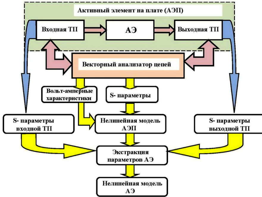
Рисунок 9. Алгоритм нелинейного моделирования мощного СВЧ АЭ
