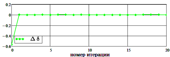
Рисунок 30. Результирующая фазовая ошибка экспериментальной ЦАР
