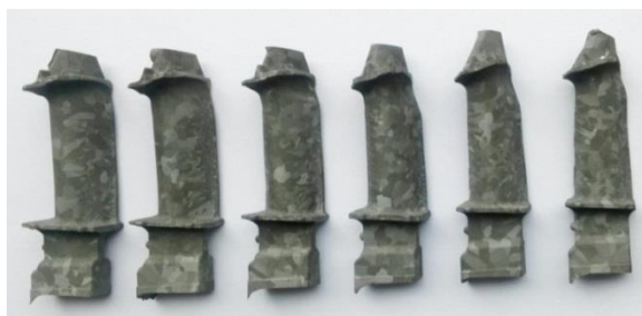
Рис. 6. Макроструктура отливок рабочих лопаток из сплава ВЖЛ21
