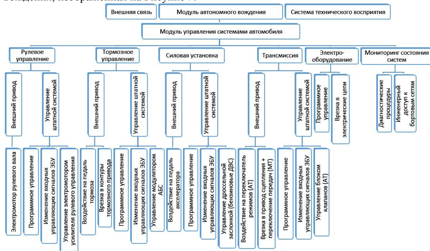
Рисунок 6. Обобщенная схема создания системы управления движением КТС
