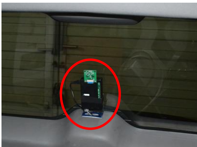
Рисунок 25. Задняя камера с модулем обработки видео
