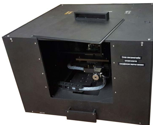
Рис. 7. Внешний вид макетного образца ОЭП контроля качества ЗГ
