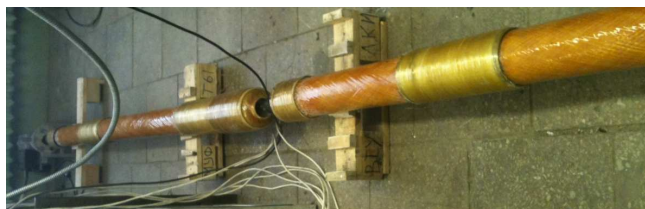
Рис. 12. Фото трубы НКТ, используемой для тепловых испытаний
