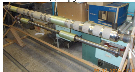
Рис. 12. Фото трубы НКТ, используемой для тепловых испытаний
