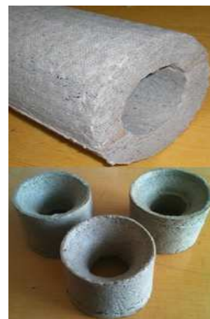
Рис. 8. Схема формования цилиндрических скорлуп из коротких базальтовых волокон (а); общий вид собранных цилиндрических скорлуп и профильных манжет для теплоизоляции стыка двух труб НКТ(б)
