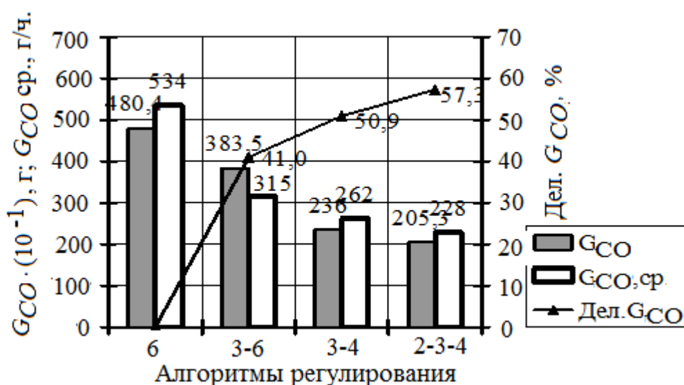
Рис. 6. Влияние алгоритма регулирования двигателя UPS 292 SC отключением цилиндров на суммарные за всё время испытаний (9 часов) выбросы оксидов углерода ( G_{CO} ), на средние за испытание на заданных режимах часовые выбросы оксидов углерода ( G_{CO,ср.} ) и на относительное изменение выбросов CO ( Дел. G_{CO} , %).
