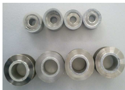
Рисунок 13. Испытание многослойных образцов на отрыв
