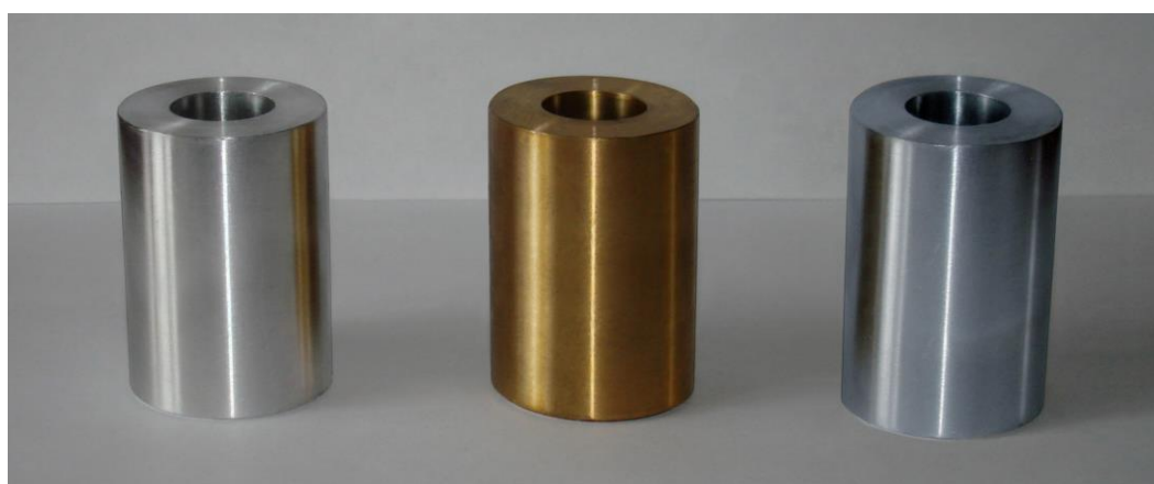
Рис. 6. Исходные заготовки (вверху) с R_0=21,4 мм, r_0=8,6 мм, H_0=40 мм и полученные из них втулки (внизу) с R=20,0 мм, r=10,0 мм, H=51,2 мм: а), г) алюминиевый сплав АВ; б), д) латунь Л63; в), е) сталь 12Х18Н9Т
