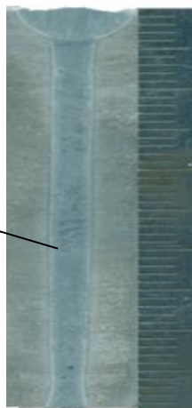
Рисунок 14. Внешний вид дна и поперечный макрошлиф шва
