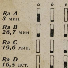
Рис. 7. Опыт проф. П. Людевига для наглядного демонстрирования законов распада.
