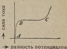
Рис. 25 Кривая изменения силы тока в ионизированном газе.
