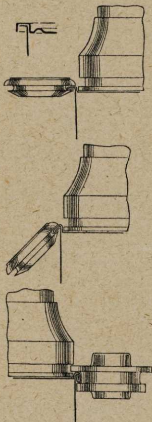
Фиг. 93. Процесс работы машины для зафальцовки донышек при массовом производстве.
