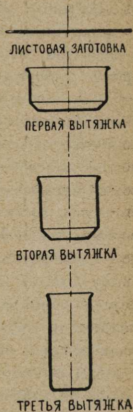
Фиг. 43. Формоизменения листовой выкройки при вытяжке.
