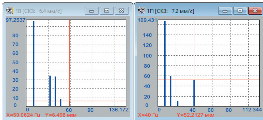
Рис. 6 (окончание). Распределение гармоник виброперемещений по передней (а) и задней (б) опорам АЭД в вертикальном (слева) и горизонтальном (справа) направлениях
