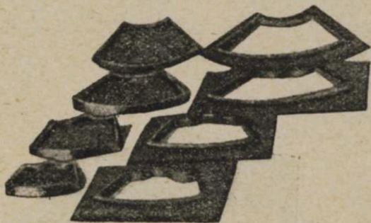
Фиг. 45. Штампы, изготовленные из стальных отливок.
