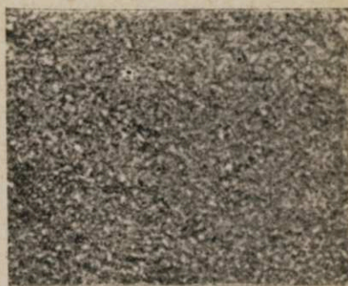
Фиг. 9. Английский чугун № 4, выплавленный на коксе.
