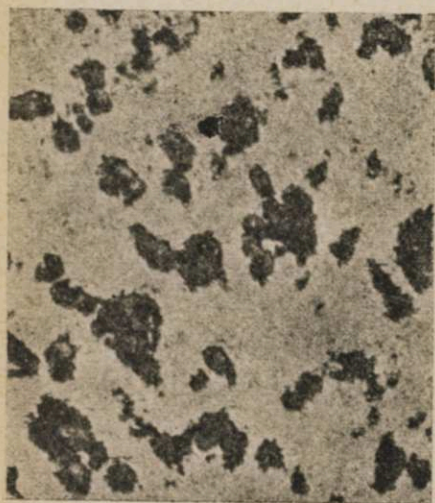
Фиг. 21. Зерна перлита в основной массе феррита (линейное увеличение в 200 раз).
