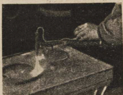
Фиг. 114. Приспособление для разрезания по кругу, при котором горелка остается в своем положении. Акц. О-во «Газоаккумулятор».
