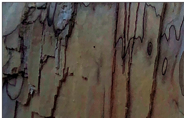
Рис. 1. «Белая гниль» древесины березы и гриб, вызывающий ее образование: а — плодовое тело трутовика настоящего ( Fomes fomentarius ); б — торцевой срез древесины; в — тангенциальный срез древесины.
