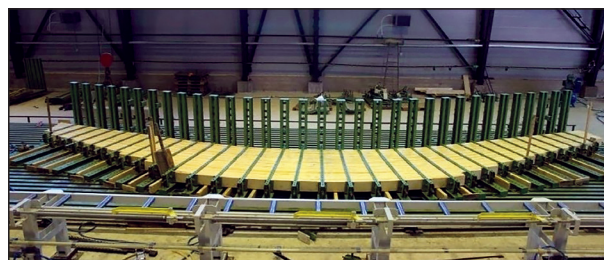
Рис. 7. Запрессовка клееных деревянных конструкций Fig. 7. Pressing of glued wooden structures
