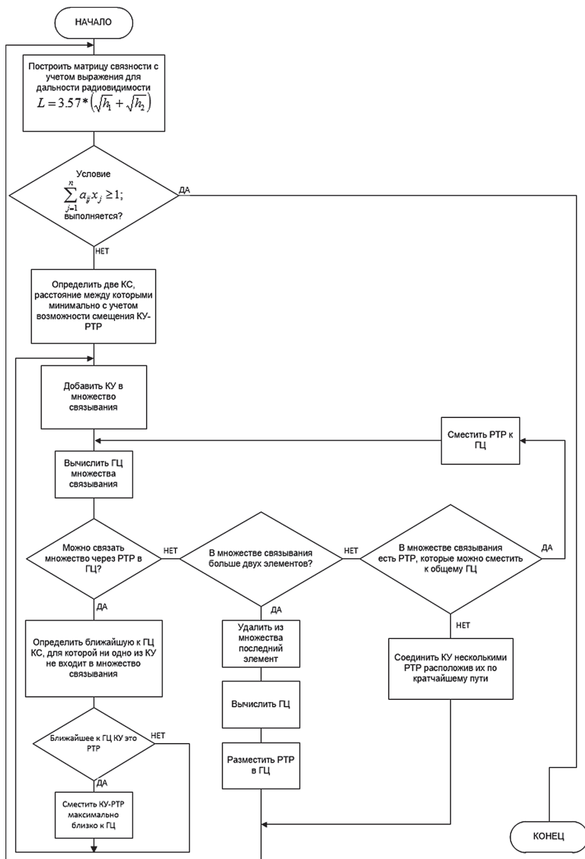
Рис. 6. Алгоритм поиска оптимального состава и размещения РТР связи
