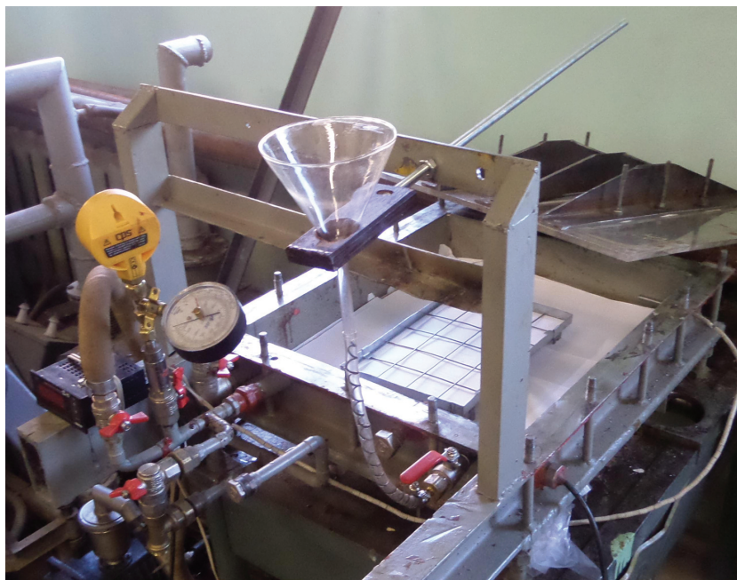
Рис. 1. Стенд для вакуумной пропитки Fig. 1. Stand for vacuum impregnation
