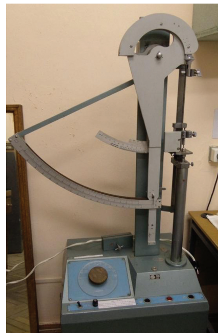
Рис. 2. Разрывная машина МРБ-100 Fig. 2. Tensile-testing machine МРБ-100
