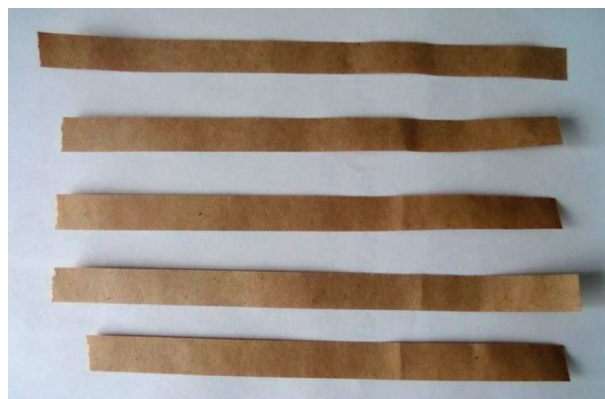
Рис. 3. Образцы пропитанной отработанными минеральными маслами бумаги для испытания на разрыв
