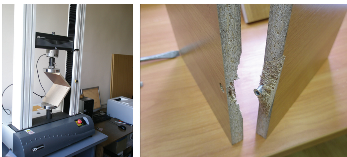
Рис. 7. Образец, закрепленный в испытательной машине, и характер разрушения углового соединения Fig. 7. The sample was mounted in the testing machine, and the nature of the destruction of the angular connection
