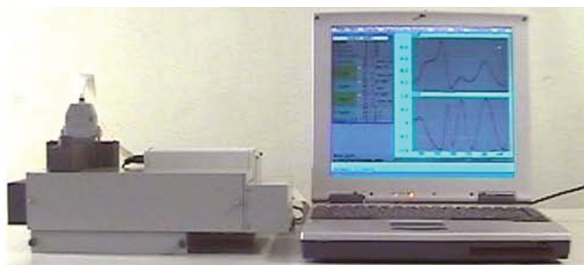
Рис. 2. Адаптивный идентификатор – 35-канальный спектроэллипсометр для использования в лабораторных условиях или в полевых условиях путем взятия образца жидкости
