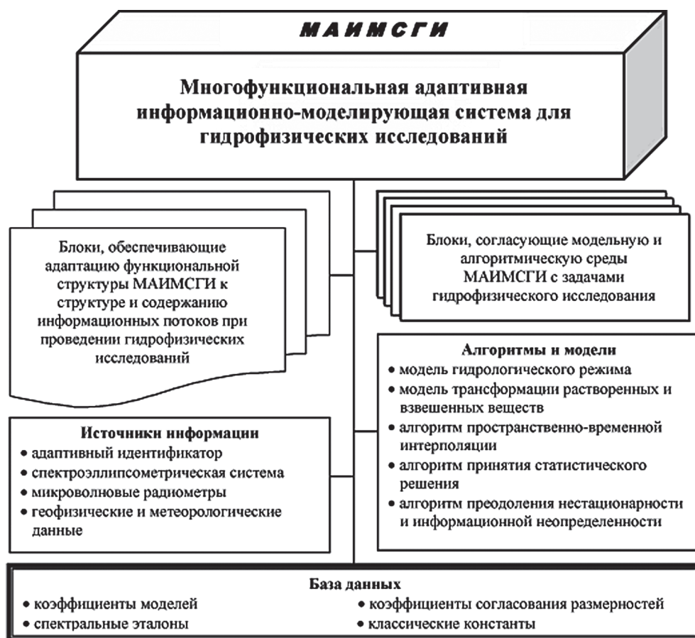
Рис. 4. Концептуальная структурная схема многофункциональной адаптивной информационно-моделирующей системы для гидрофизических исследований (МАИМСГИ), ориентированная на оценку физико-химических характеристик водных объектов
