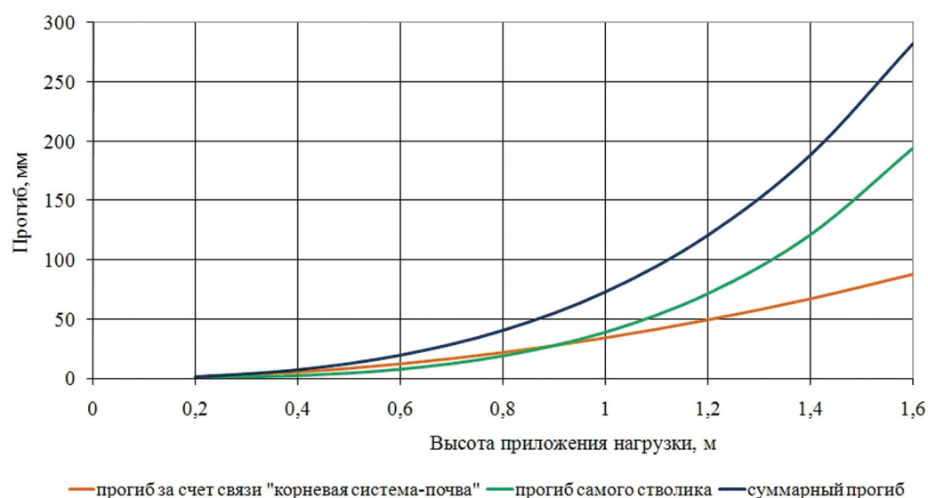
Рис. 3. Влияние заделки на прогиб стволика березы ( d_0 = 25,4 мм, H = 3,92 м) Fig. 3. Effect of termination on the deflection of birch trunk ( d_0 = 25,4 мм, H = 3,92 м)
