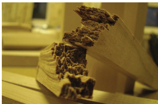
Рис. 4. Поперечное разрушение образцов Fig. 4. Cross the destruction of samples
