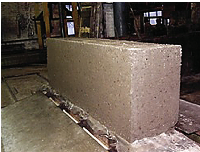
Рис. 3. Освобождение блоков из пресс-форм Fig. 3. The release of the blocks from the molds
